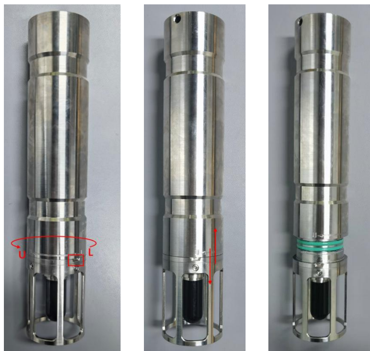
图 3 CH500/CH600 外壳拆卸示意图
