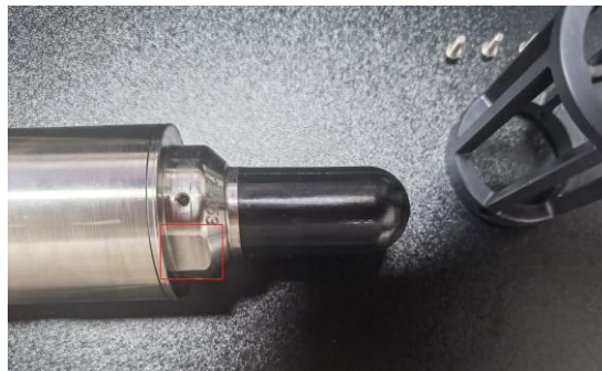
图 18 水听器末端预留扳手位
